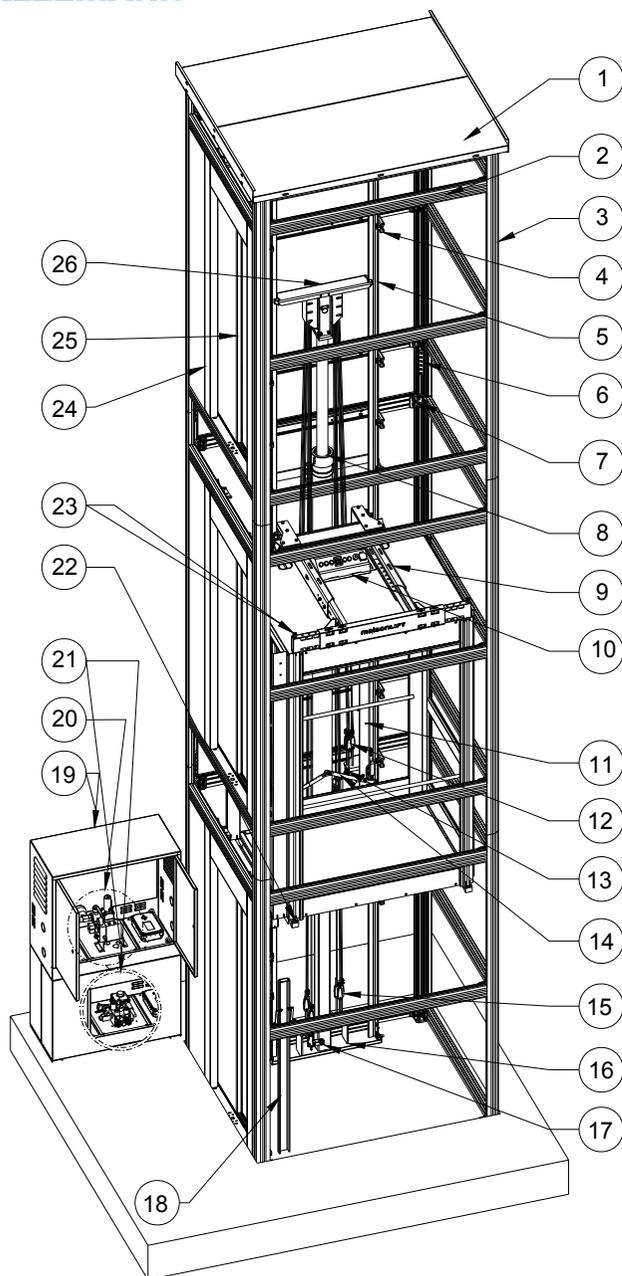
1. КРЫША ДЛЯ МЕТАЛОКАРКАСНОЙ ШАХТЫ
